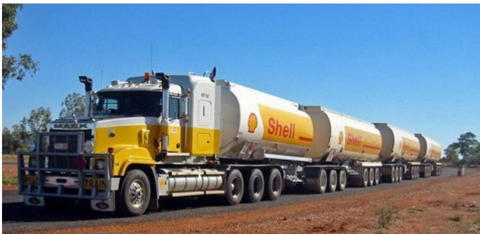
La importancia del transporte remolcado en la economía del combustible puede verse en este curioso tren de acoplados de transporte de combustible. Sin embargo este tipo de vehículos son extremadamente peligrosos por el agrandamiento de los radios de giro de los acoplados ubicados al final del "tren".
